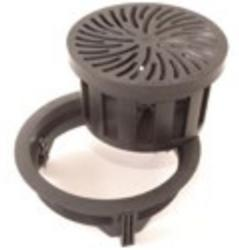
El difusor Smart-Air de ASM es un difusor de aire de velocidad baja. Diseñado para su uso en sistemas de piso elevado, utilizando el área debajo del piso elevado como una cámara plena de aire presurizado. La atractiva tapa con diseño de turbina produce un patrón de descarga en forma de hélice de baja velocidad que alcanza una alta velocidad de inducción de aire acondicionado, con lo que se obtiene una circulación óptima y condiciones de comodidad para las personas.
